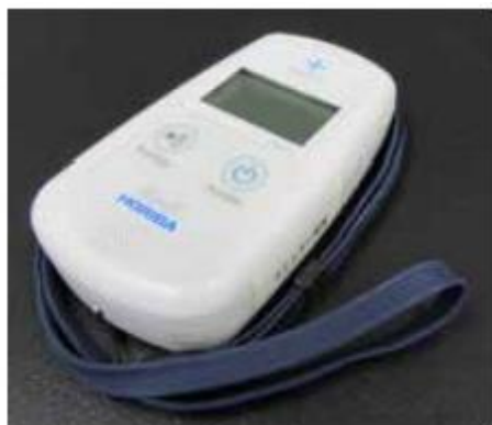
簡易 \gamma 線測定器
